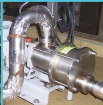
Dichtungslose Ringkolbenpumpe Lebensmittel- und Pharmaindustrie
