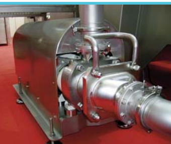
CIP und SiP fähige Schraubspindelpumpe Lebensmittel und Pharmaindustrie
